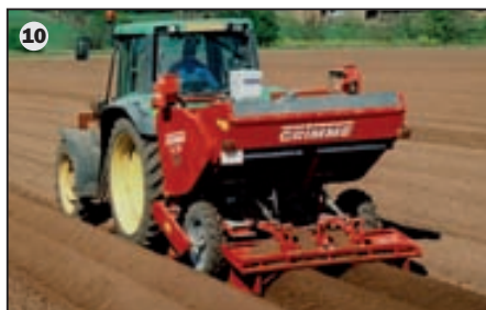
GL 32 RB: Pootmachine, twee of vierrijg, met extra toevoerbanden voor voorgekiemde aardappelen (9)
