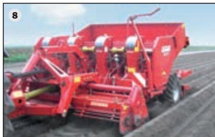
GL 34: 5 in 1-frees, poot-rugvormcombinatie, doet tot 5 werkgangen in één keer (7)
