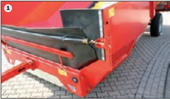
1 Met slechts enkele handgrepen is het geveerde instortkleed in hoogte te verschuiven. Zo is de stortbunker snel gereed voor verschillende maten kippers.
