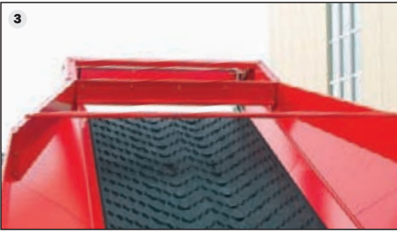
De achterplaat in de instortrechter zorgt bij de RH 12-40, RH 12-40 E en RH 16-40 voor een geregelde productstroom en een gelijkmatige toevoer naar de volgmachines.
