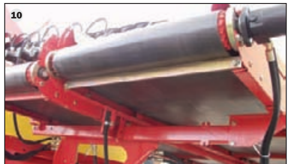
10 Grond- en productafvoerbanden zijn met een verlenging van 300 cm naar 350 cm leverbaar.
