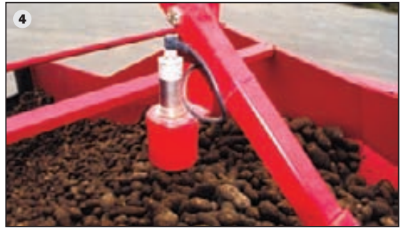
Het CAPACITY-CONTROL systeem regelt de bunkerbodemsnelheid automatisch en zorgt voor een optimale productstroom op de gehele inschuurlijn. Het systeem werkt m.b.v. een ultrasone sensor. Uw voordeel: Een optimale benutting van uw lijn zonder handmatig naregelen.
