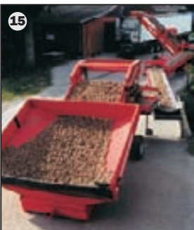
Comfortabele oplossing: De elektrische schakeling van links/uit/rechts van de afvoerbanden wordt optimaal bestuurd via de bedieningsterminal
