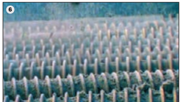
6 Door middel van het optionele TURBO-CLEAN laten de spiraalrollen zich met hoge middelpuntvliedende krachten in een mum van tijd reinigen.
