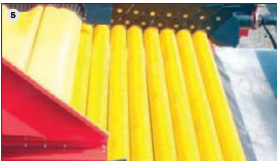
5 Vanaf de RH 20-45 is de stortbunker met 2 extra reinigingsrollen leverbaar.
