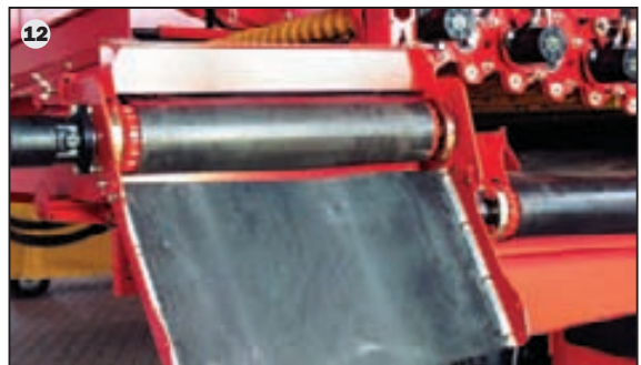
Soepele overgang: Een rubberen glijgoot zorgt voor een productvriendelijke afgifte op bijvoorbeeld een lager geplaatste duoband.
