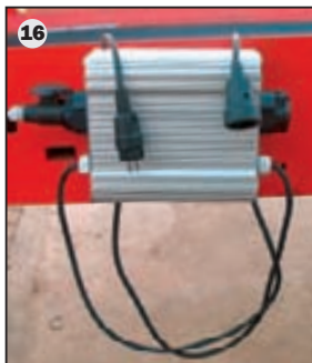
Comfortabele oplossing: De elektrische schakeling van links/uit/rechts van de afvoerbanden wordt optimaal bestuurd via de bedieningsterminal
