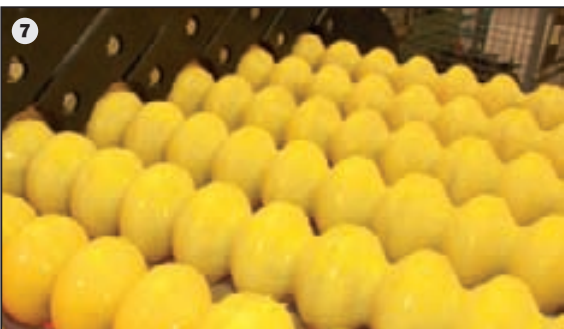
Goed gesorteerd: Er is keuze uit meerdere maten voorsorteerrollen van polyurethaan. Door middel van de hydraulische rolafstandsverstelling kan de gewenste sorteermaat exact worden ingesteld.
