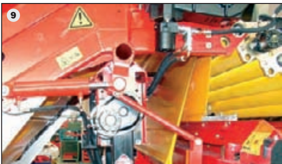
9 Hydraulische afstands- en hellingshoek verstelling van de rollenset zorgen voor een nog comfortabelere en flexibelere aanpassing aan de verschillende omstandigheden.
