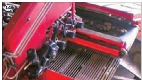
14 Een zeefband in plaats van een grondafvoerband, scheidt kleine aardappelen van losse grond.
