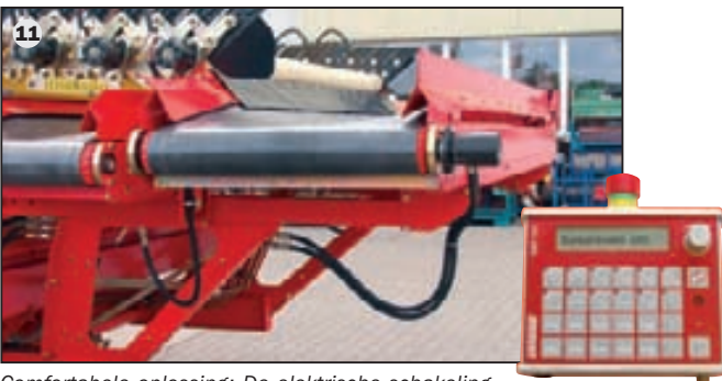
Comfortabele oplossing: De elektrische schakeling van links/uit/rechts van de afvoerbanden wordt optimaal bestuurd via de bedieningsterminal
