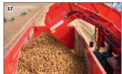
Ingesteld voor maximaal productvriendelijkheid: Door de speciale bunkervorm is het mogelijk de aardappelen op de bodem van de meeste aanhangers te leggen – door middel van de 3 separaat hydraulisch verstelbare bunkersecties – waardoor valhoogten aanzienlijk worden gereduceerd. Voor nog meer capaciteit is het ook mogelijk om tijdens het rooien te lossen.
