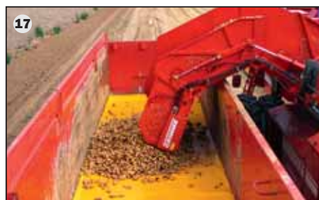
Ingesteld voor maximaal productvriendelijkheid: Door de speciale bunkervorm is het mogelijk de aardappelen op de bodem van de meeste aanhangers te leggen – door middel van de 3 separaat hydraulisch verstelbare bunkersecties – waardoor valhoogten aanzienlijk worden gereduceerd. Voor nog meer capaciteit is het ook mogelijk om tijdens het rooien te lossen.
