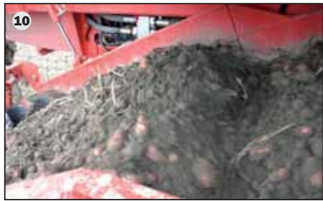
Daarmee loopt het goed: Met de optionele graafband wordt de zeefcapaciteit verhoogd. De snelheid kan aan de rooiomstandigheden traploos worden aangepast.
