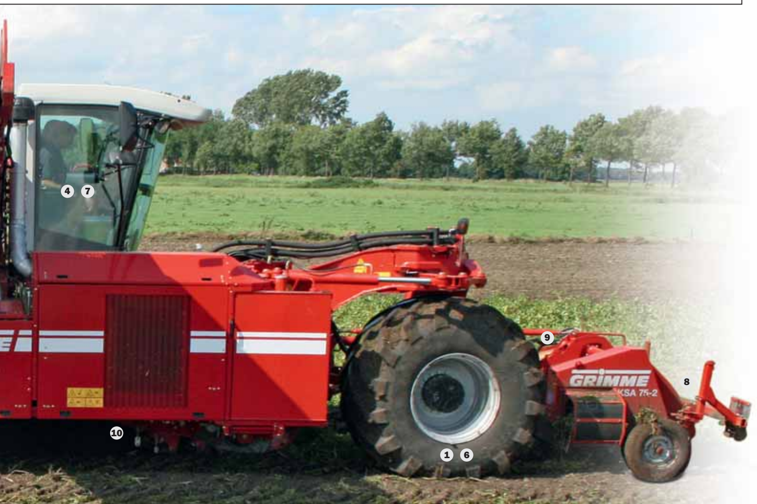
Voor een hoge zeef- en reinigingscapaciteit zijn verschillende reinigers aan te beiden, die in een logische volgorde zijn geplaatst. Naar keuze kan de axiaalrollenreiniger samen met een egelband worden uitgevoerd. Daarbij kan ook voor het VARIO RS worden gekozen. De axiaalrollenreiniger reinigt kluiten, grond etc. en de egelband zal de laatste loof- of onkruidresten uit de productstroom halen.
