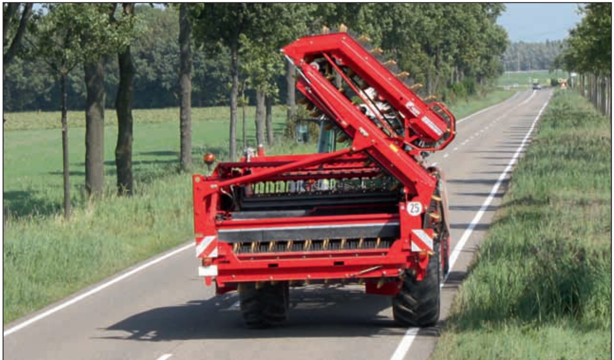
D'un champ à l'autre : toutes les machines conçues pour le système « MAXI-Beet » ont une largeur de transport sur route n'excédant pas les limites de 3,30 m.
