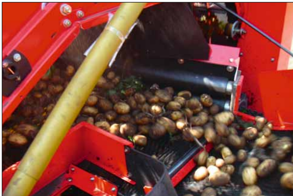
Réglage manuel : les 6 peignes de retenue (3 en haut et 3 en bas) sur la chaîne effaneuse
