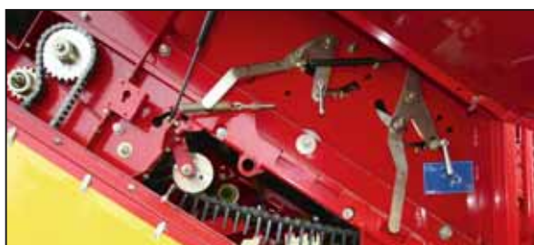
Réglage manuel : les 6 peignes de retenue (3 en haut et 3 en bas) sur la chaîne effaneuse
