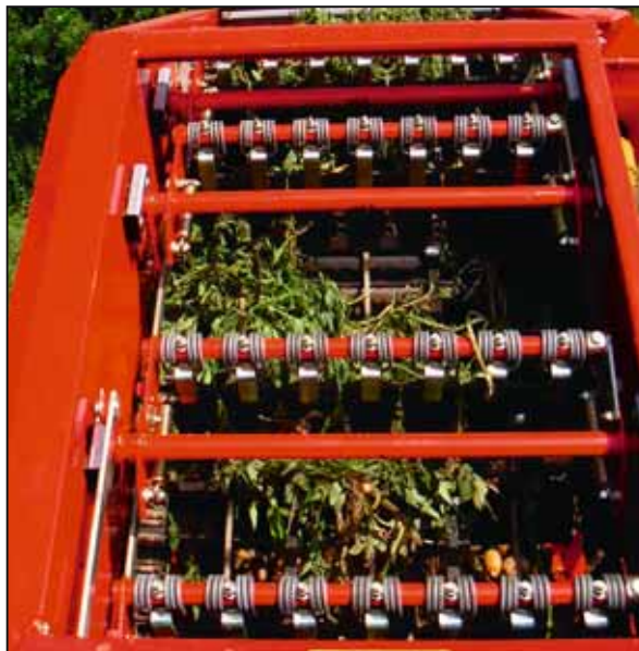
Douce et efficace : chaîne effaneuse à grandes mailles avec ameneurs souples en PU (écarts de 210 mm, 280 mm)
